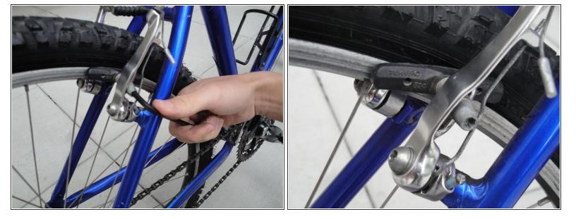
Loosen the brake pad bolt.
