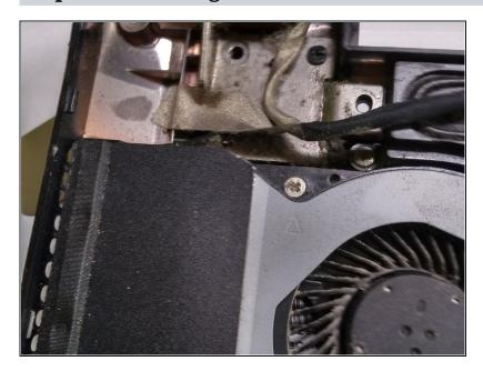
remove screw holding the fan tot the laptop.
