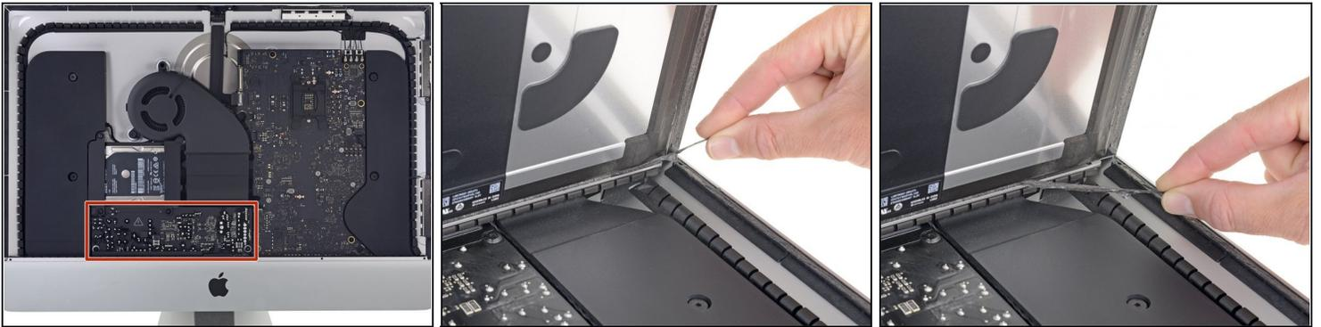
**⚠** Fa' molta attenzione a non toccare i conduttori del condensatore o le saldature esposte sul retro dell'alimentatore (riquadri in rosso).
