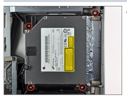
Rimuovere le quattro viti Torx T10 che fissano l'unità ottica al case esterno.
