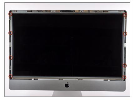
Rimuovi le otto viti Torx T10 che fissano l'LCD al case esterno.
