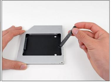
• Rimuovi il posizionatore di plastica dal case del disco rigido dell'alloggiamento ottico, premendo una delle clip poste lateralmente e sollevandolo dal case.
