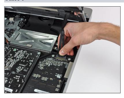
Ruota il display sollevandolo dal case esterno quanto basta a disconnettere il cavo della retroilluminazione LED dalla scheda di controllo LED.
