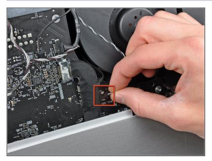
Scollegare il connettore del cavo del sensore termico dell'unità ottica dal connettore femmina sulla scheda logica.
