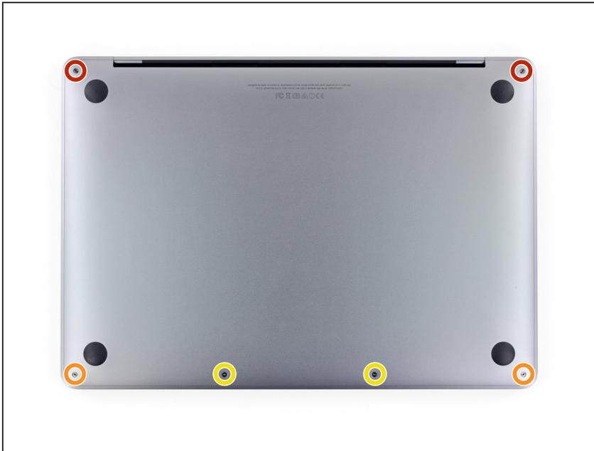
**⚠** Prima di smontare il tuo MacBook Pro, scarica la batteria sotto il 25%. Una batteria al litio-ioni carica può prendere fuoco e/o esplodere se viene forata accidentalmente.
