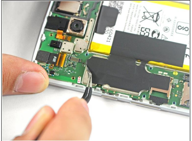
**!** Stai molto attento a non perforare la batteria con attrezzi affilati. Una batteria al litio-ioni danneggiata può prendere fuoco e/o esplodere.
