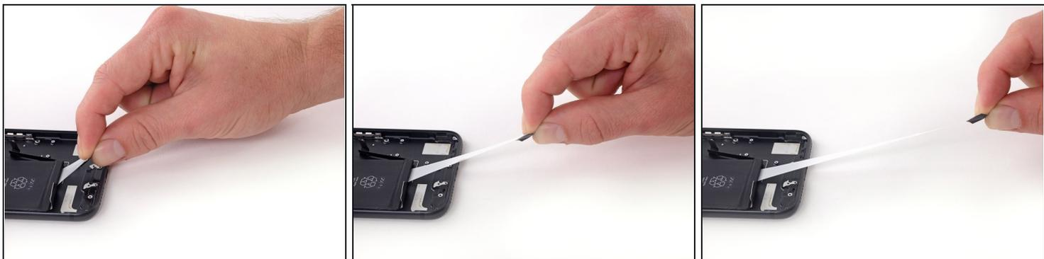
**⚠** Cerca di mantenere le strisce piatte e non aricchiate durante la procedura; le strisce aricchiate si incollano insieme e si rompono invece di staccarsi senza problemi.
