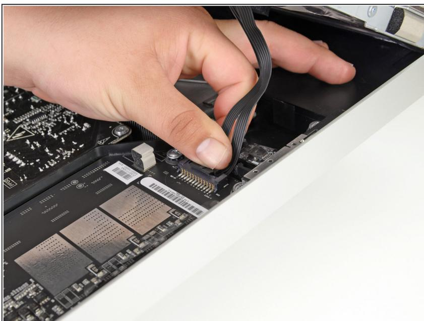
**⚠** Questo passaggio ti farà avvicinare le mani al retro esposto dell'alimentatore. Per evitare delle scosse ad alto voltaggio dai diversi condensatori ad alta capacità attaccati alla scheda, **NON** toccare il retro dell'alimentatore.
