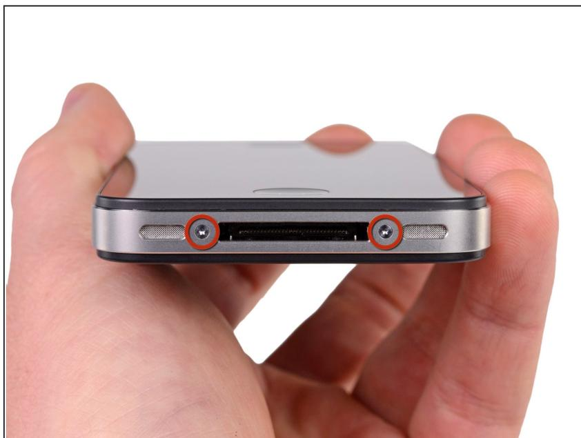
**⚠** Prima di iniziare, scarica la batteria del tuo iPhone sotto il 25%. Una batteria al litio-ioni carica può prendere fuoco e/o esplodere se viene perforata accidentalmente.
