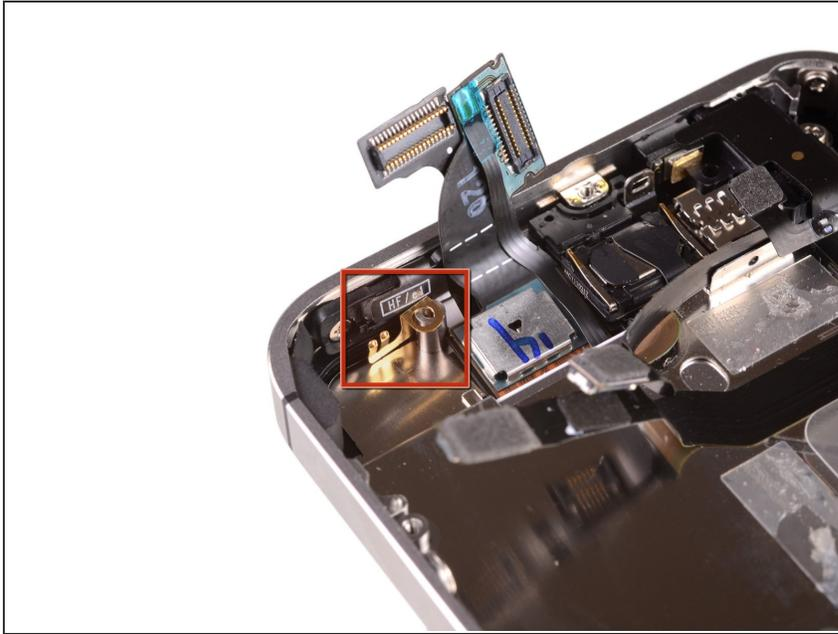
**⚠** Stai attento non perdere il piccolo dito metallico per la messa a terra della fotocamera posteriore, vicino al pulsante di accensione. Questa lamella è posizionata sulla parte superiore della scheda, avvitata e coperta con del nastro adesivo in plastica nera.
