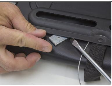
Hardbackplatte mit Schraubendreher leicht anheben und die Gewindeplatte darunter schieben.
