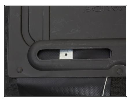
Die Gewindeplatte in der Aussparung mittig ausrichten.
