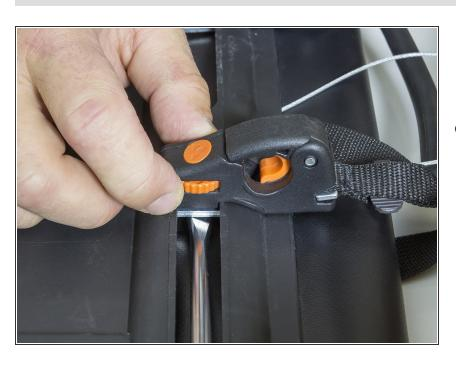
Den QMR-Haken auf der Gewindeplatte positionieren. Mit orangenem Feststellrädchen die Schraube in der Gewindeplatte festziehen.
