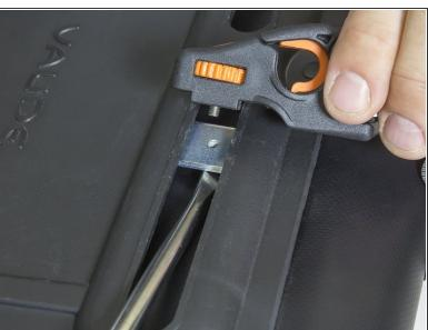
Mit dem Schraubendreher die Gewindeplatte anheben, damit die Schraube des QMR-Hakens greifen kann.
