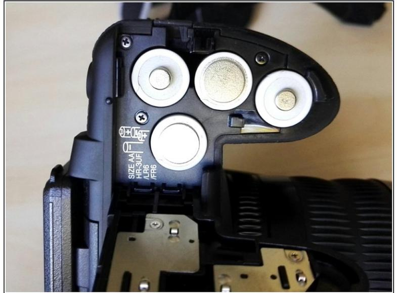
**i** Hier sieht man jetzt die leeren Zellen-Schächte. Die Polarität der Zellen ist aufgedruckt.
