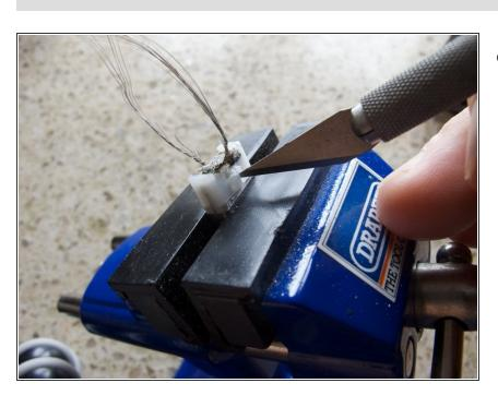
Per prima cosa taglia via la plastica stampata che è probabilmente usata come diffusore per il LED di stato.
