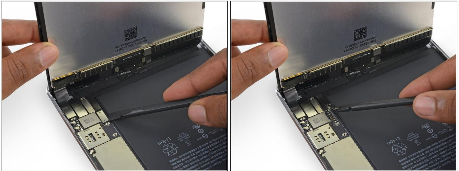
**⚠** Quando scolleghi qualsiasi connettore a pressione dalla scheda logica, assicurati di alzare il connettore verso l'alto per evitare di rompere il socket della scheda.
