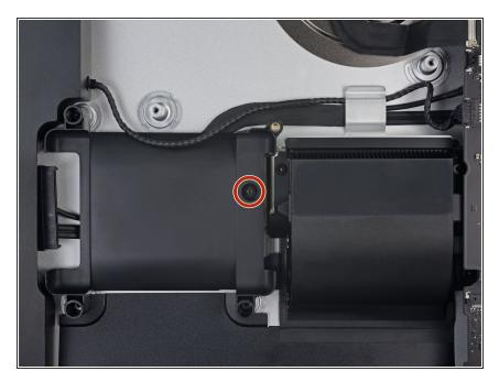
Svita la vite Torx T8 da 7,3 mm che fissa il supporto dell'unità alla scocca posteriore.
