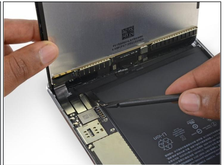
**⚠** Quando scolleghi qualsiasi connettore a pressione dalla scheda logica, assicurati di alzare il connettore verso l'alto per evitare di rompere il socket della scheda.
