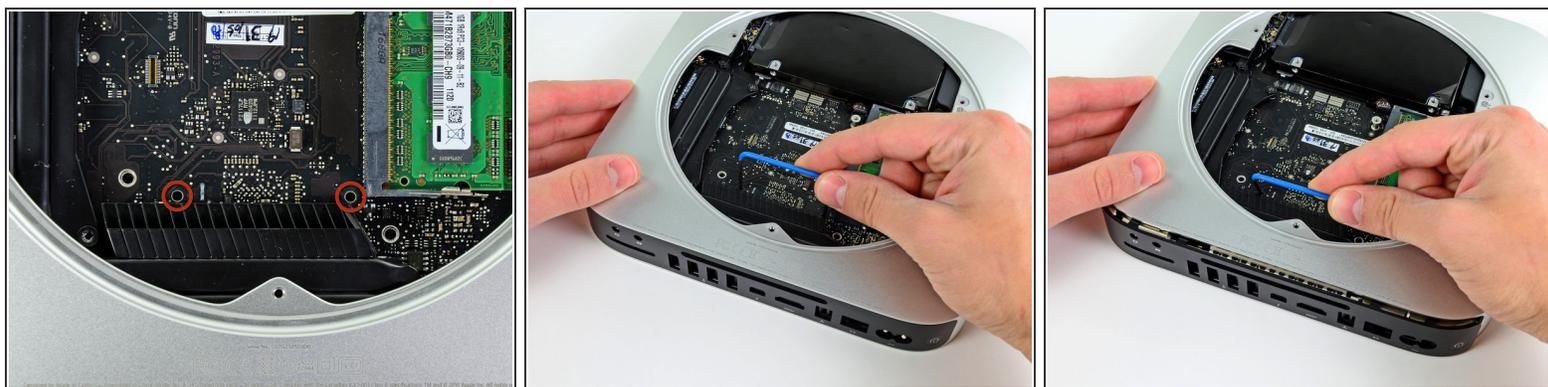
**⚠** Per rimuovere la scheda logica, occorre inserire le due aste cilindriche dell'attrezzo per la rimozione della scheda logica per Mac Mini nei fori evidenziati in rosso. Inserire gli strumenti in altri fori rispetto a quelli evidenziati in rosso potrebbe danneggiare irrimediabilmente la scheda logica.
