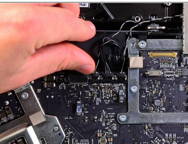
Estrarre il connettore del sensore temperatura del disco rigido verso il bordo superiore dell'iMac per scollegarlo dal connettore femmina sulla scheda logica.
