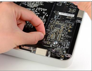
Estrarre il connettore del cavo della sincronizzazione verticale dal connettore femmina sulla scheda di azionamento LED, vicino all'angolo superiore sinistro dell'iMac.
