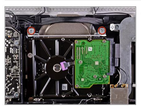
Rimuovere le due viti Torx T10 da 9 mm che fissano la staffa superiore del disco rigido al case esterno.
