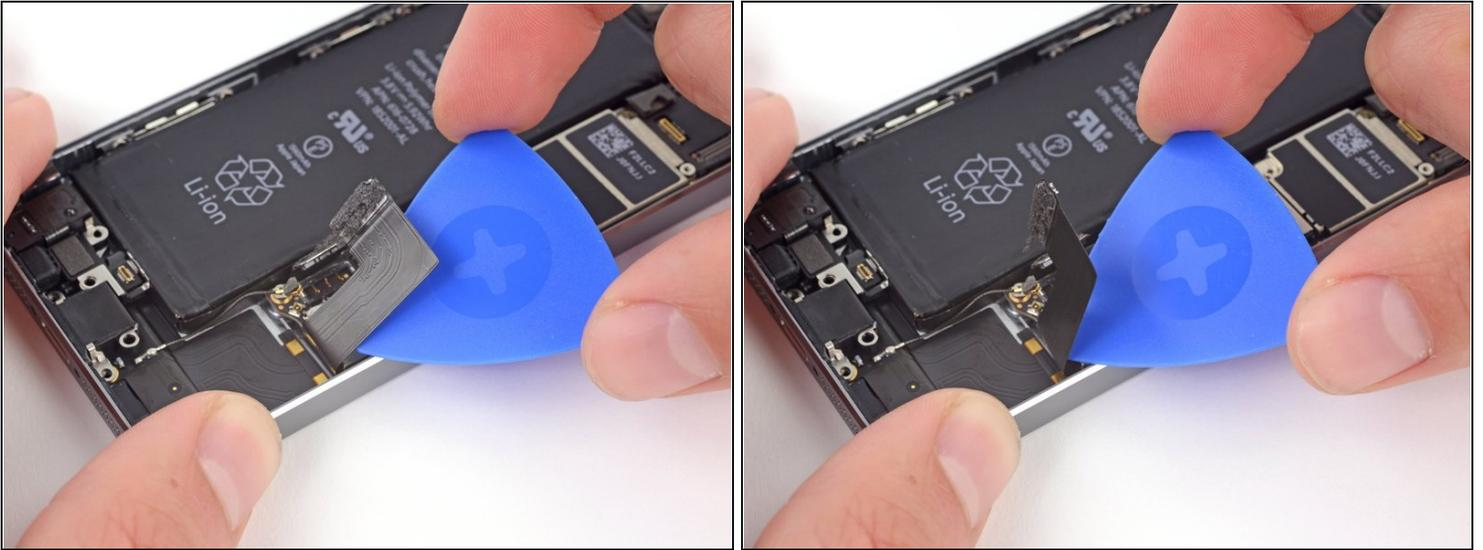
ⓘ Il cavo dati del connettore Lightning è attaccato alla scheda logica e al case posteriore con un adesivo poco tenace.
