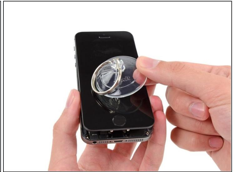
**⚠ Non provare a rimuovere completamente il pannello dal case posteriore poiché ci sono ancora alcuni delicati cavi a nastro tra le due parti.**
