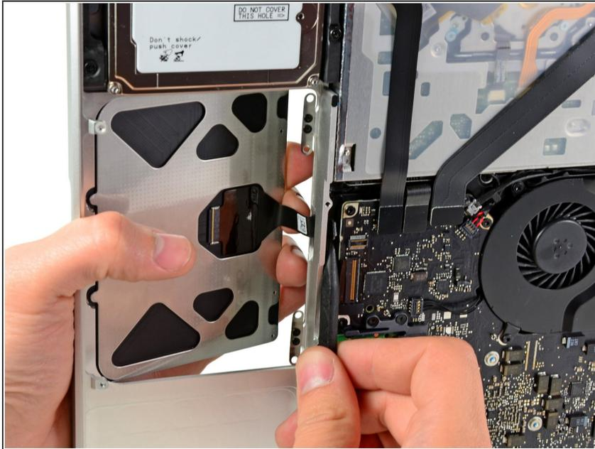
**i** Se stai installando un trackpad di ricambio che non ha il cavo a nastro già collegato, dovrai usare il cavo del trackpad originale.
