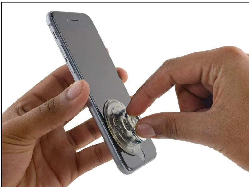
① Con l'apertura del display del 6s, si staccherà una sottile striscia di adesivo attorno al perimetro dello schermo. Se preferisci sostituire l'adesivo, tieni pronte delle nuove strisce adesive prima di continuare. È possibile completare la riparazione senza sostituire l'adesivo e probabilmente non noterai alcuna differenza nella funzionalità.
