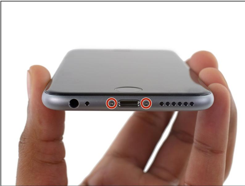
**⚠** Prima di iniziare, scarica la batteria del tuo iPhone sotto il 25%. Una batteria agli ioni di litio carica può prendere fuoco e/o esplodere se viene perforata accidentalmente.
