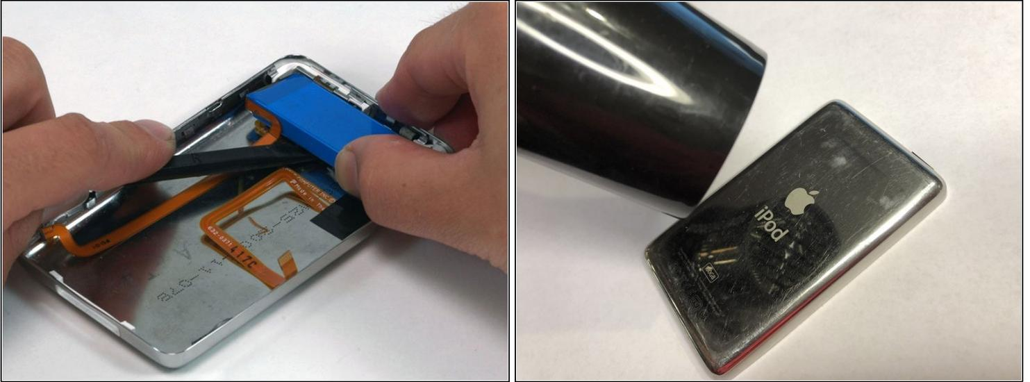
**⚠** La batterie est attachée à la coque arrière avec de l'adhésif. Veillez à ne pas déchirer la prise casque orange ou les nappes du bouton lorsque vous retirez la batterie.
