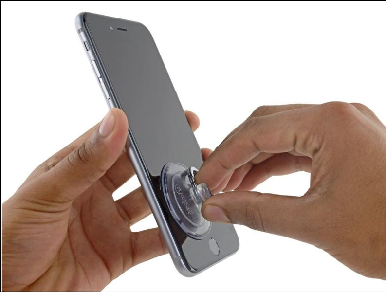
ⓘ Con l'apertura del display del 6s Plus, si staccherà una sottile striscia di adesivo attorno al perimetro dello schermo. Se preferisci sostituire l'adesivo, tieni pronte delle nuove strisce adesive prima di continuare. È possibile completare la riparazione senza sostituire l'adesivo e probabilmente non noterai alcuna differenza nella funzionalità.
