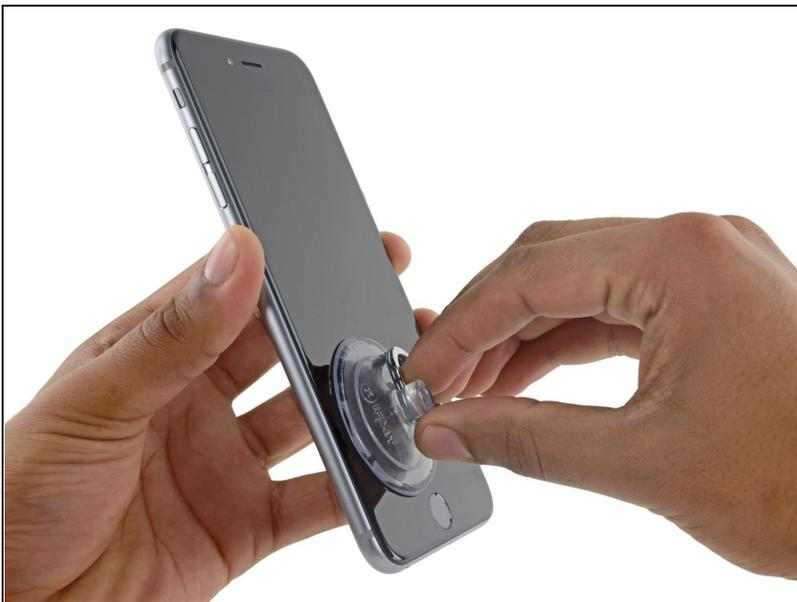
① Con l'apertura del display del 6s Plus, si staccherà una sottile striscia di adesivo attorno al perimetro dello schermo. Se preferisci sostituire l'adesivo, tieni pronte delle nuove strisce adesive prima di continuare. È possibile completare la riparazione senza sostituire l'adesivo e probabilmente non noterai alcuna differenza nella funzionalità.
