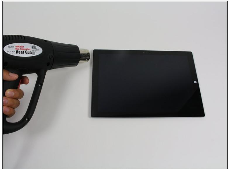
**⚠** Prima di iniziare, scarica la batteria del Surface Pro sotto il 25%. Una batteria agli ioni di litio carica può prendere fuoco o esplodere se danneggiata accidentalmente durante la riparazione.
