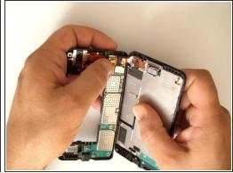
Sistema l'altoparlante voce sul nuovo display e inizia il rimontaggio.
