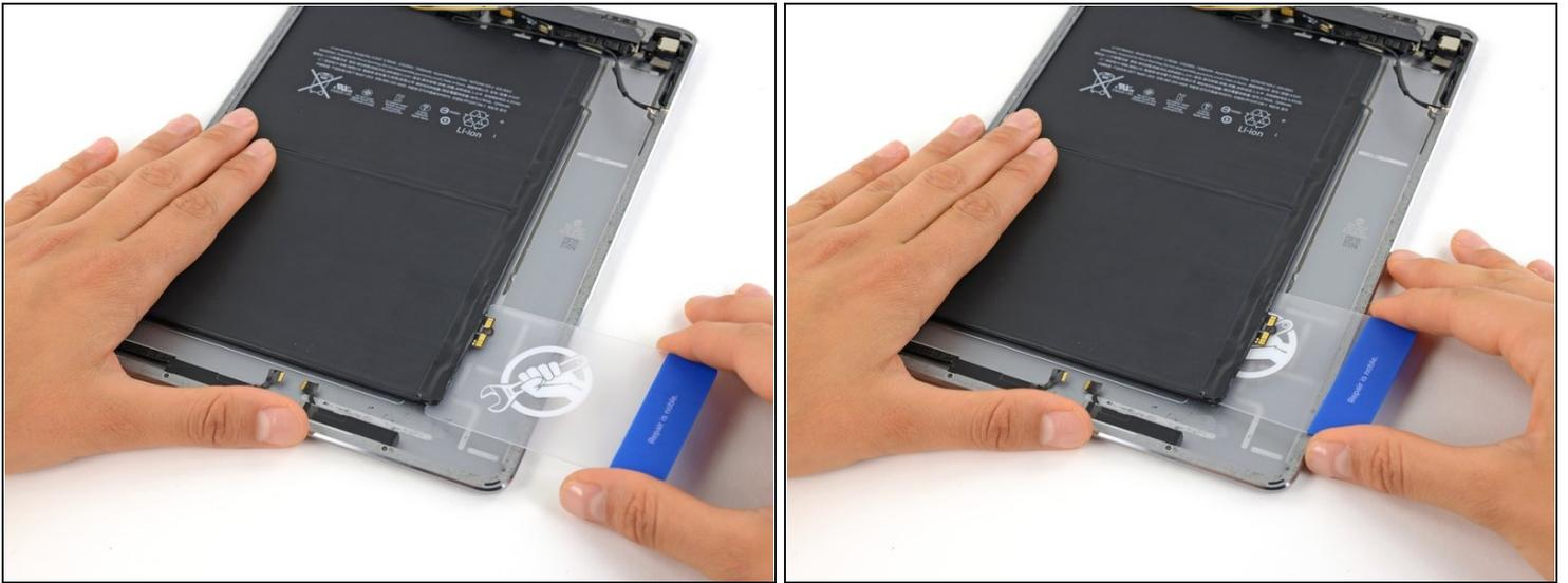
**⚠** Nel corso della seguente procedura, dovrai far scorrere una scheda di plastica tra la batteria e il retro dell'iPad per separare l'adesivo che li tiene insieme. Fai attenzione a tenere la scheda più piatta possibile per evitare di piegare la batteria, che si potrebbe danneggiare rilasciando sostanze chimiche pericolose.
