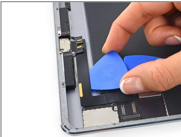
**i** Il cavo del connettore Lightning è attaccato alla custodia con un adesivo. Per staccare l'adesivo è necessario far scorrere un plettro di apertura tra il cavo e la custodia. Fare molta attenzione a non tagliare il cavo del connettore Lightning.
