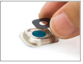
● 现在来更换新的相机镜头。撕掉上面的保护膜,将玻璃片安装到镜头环上。
