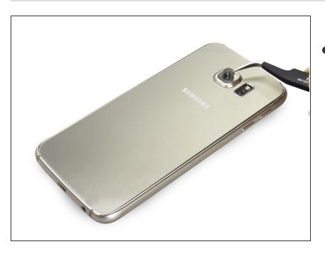
如果你的S6的相机镜头玻璃损伤严重,可以直接将它拆掉,不过请务必小心。注意不要划伤摄像头或金属环。
