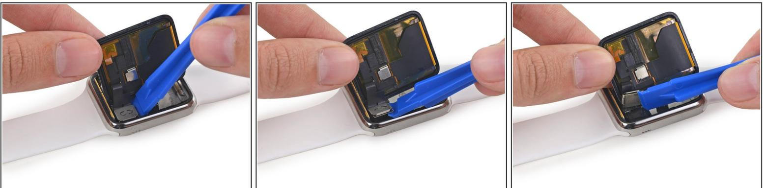
**i** Il connettore del cavo del display e del touch sono fissati al di sotto di una piccola staffa metallica che aderisce all'altoparlante.
