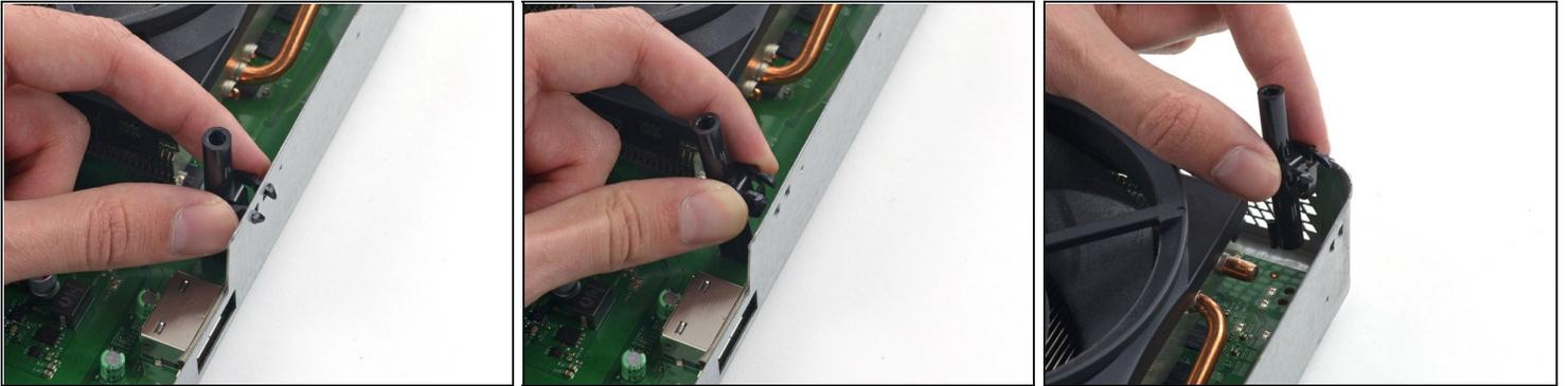
① Due supporti in plastica nera per le viti sono fissati al telaio con delle alette elastiche in plastica.
