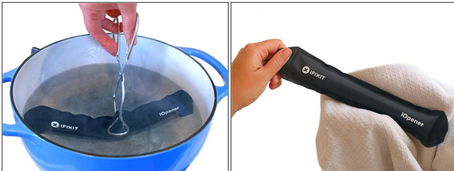
ⓘ Se non hai un microonde, segui questo passo per scaldare il tuo iOpener in acqua bollente.
