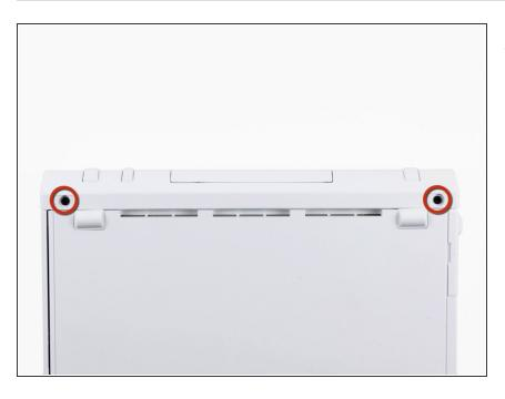
Svita le due viti Tri-Wing da 8,3 mm nascoste sotto le coperture appena rimosse.
