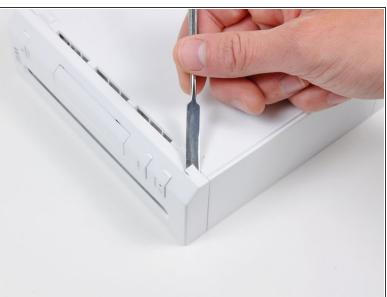
Usa uno spudger in metallo per rimuovere le coperture in plastica bianca delle viti incastrate nella copertura inferiore vicino alla parte anteriore della Wii.
