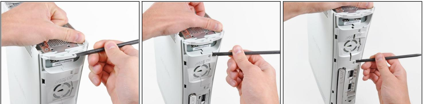
ⓘ La scocca superiore e inferiore sono unite da diverse clip sia sul fronte sia sul retro della console. Questi ganci devono essere rilasciati per separare la scocca inferiore dalla console.
