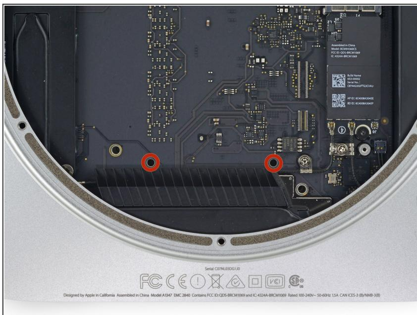
**⚠** Per rimuovere la scheda logica, è necessario inserire le due aste cilindriche dello strumento di rimozione della scheda logica Mac mini nei fori evidenziati in rosso. L'inserimento di strumenti in qualsiasi altro foro della scheda logica diverso da quelli evidenziati in rosso può distruggere la scheda logica.
