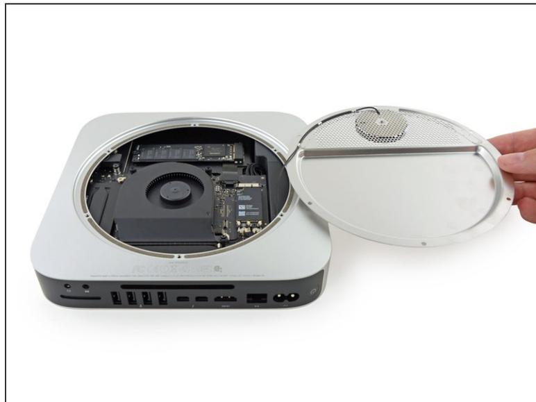
**!** Non rimuovere completamente il piatto antenna; è connesso al Mac mini tramite un cavo di antenna.
