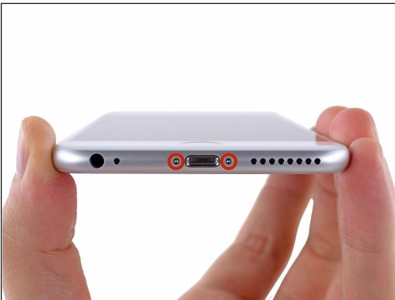
**⚠️** Prima di smontare il tuo iPhone, scarica la batteria del tuo iPhone sotto il 25%. Una batteria al litio-ioni carica può incendiarsi e/o esplodere se forata accidentalmente.
