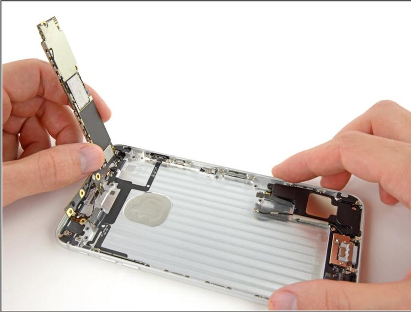
**⚠ Non rimuovere la scheda logica. In questo momento è ancora ancorata al case posteriore tramite un connettore di antenna.**
