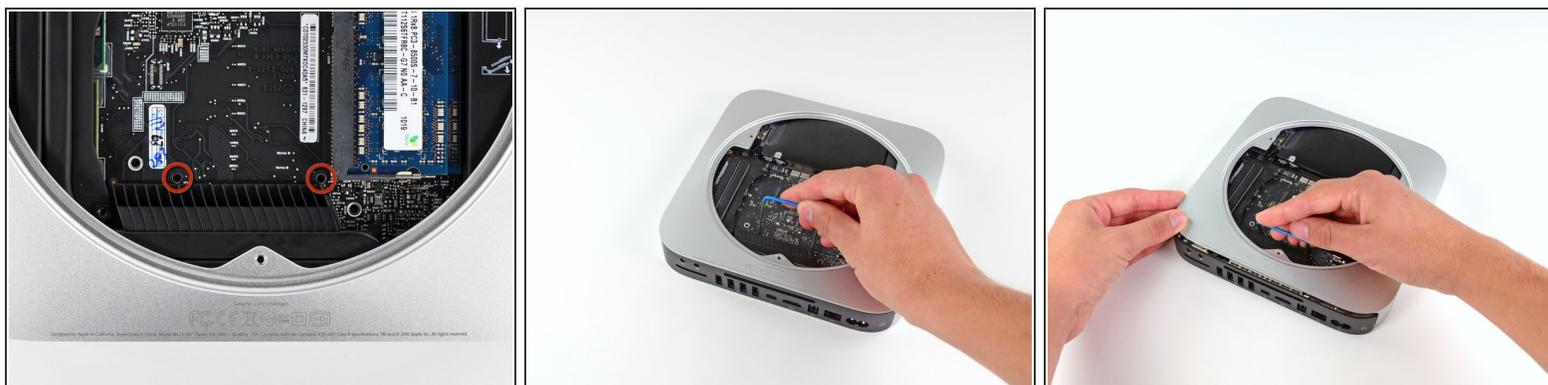
**i** Per avere spazio a sufficienza per la rimozione del disco rigido, occorre rimuovere leggermente la scheda logica. A tale scopo, occorre inserire due aste cilindriche nei fori evidenziati in rosso.
