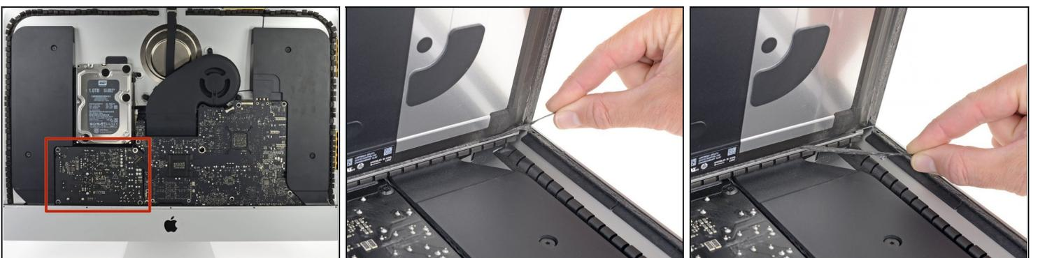
**⚠** **Attenzione a non toccare i contatti dei condensatori o qualunque punto di saldatura esposto sul retro dell'alimentatore (riquadro rosso).**
