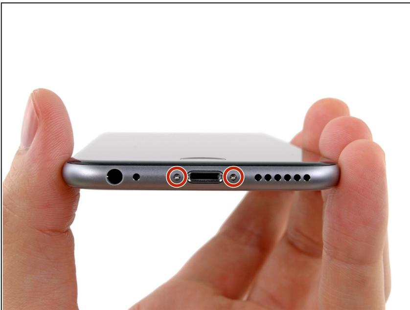
**⚠** Prima di smontare il tuo iPhone, scarica la batteria sotto il 25%. Una batteria agli ioni di litio carica può incendiarsi e/o esplodere se forata accidentalmente.
