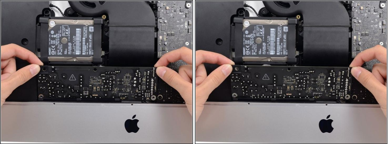
⚠ Mentre sei alle prese con l'alimentatore **stai molto attento a non toccare** i contatti dei condensatori o le saldature sul retro dell'alimentatore. Spostalo toccando esclusivamente i bordi della scheda.
