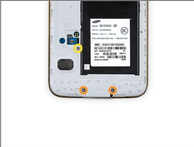
**i** Capovolgi il telefono e rimuovi le viti seguenti dal lato batteria del telaio centrale:
