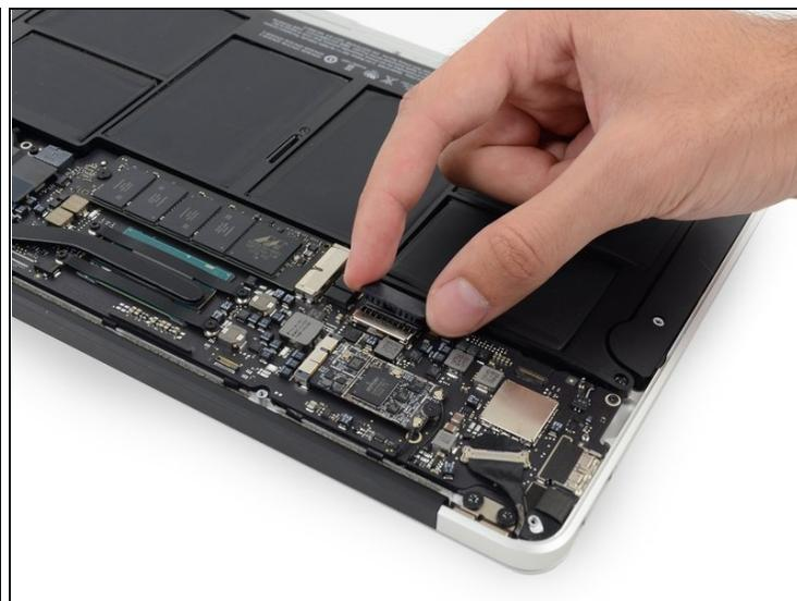
**⚠** In questo passaggio scollegherai la batteria per evitare di far fare corto circuito a qualsiasi componente durante la riparazione.
