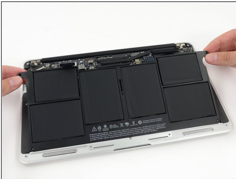
⚠ Quando si maneggia la batteria, evitare di comprimere o toccare le sei celle polimeriche di litio esposte.
