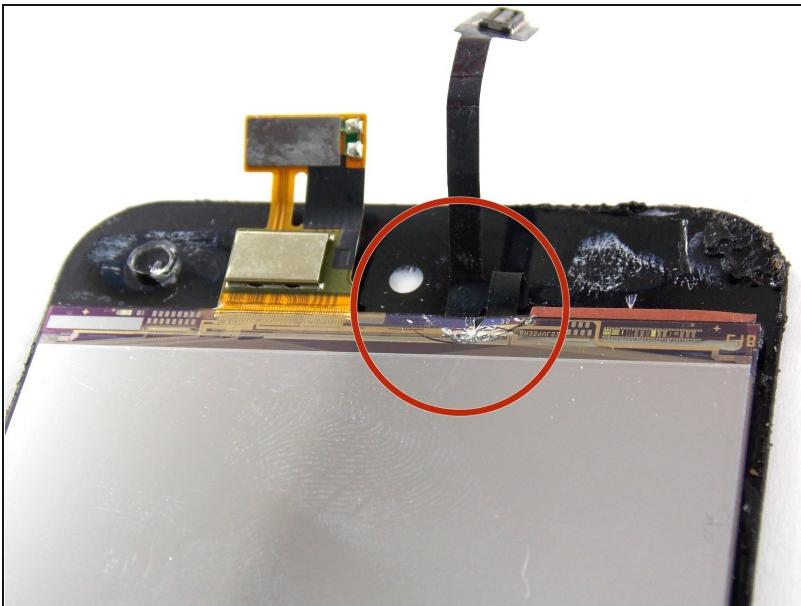
ⓘ Al doblar el cable flex de forma incorrecta la pantalla no entra completamente en el socket y se quiebra al tratar de cerrar el iPod.
