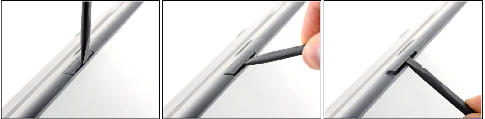
**i** La batteria a bottone ricaricabile ML2032 si trova in un carrello nel bordo posteriore della tastiera.
