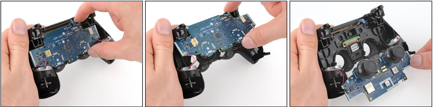
⚠ Fai attenzione a non stressare i cavi del motore di vibrazione. [Segui questa guida per risaldare i motori di vibrazione nel caso si stacchino dalla scheda madre.](#)
