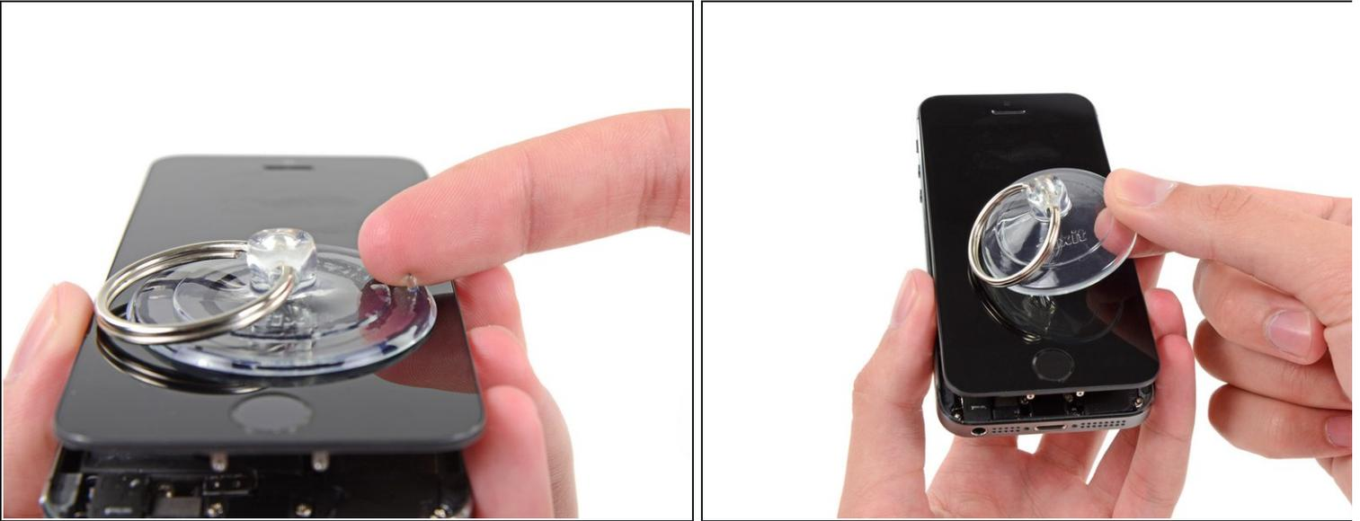
**⚠ Non provare a rimuovere completamente il pannello dal case posteriore poiché ci sono ancora alcuni delicati cavi a nastro tra le due parti.**
