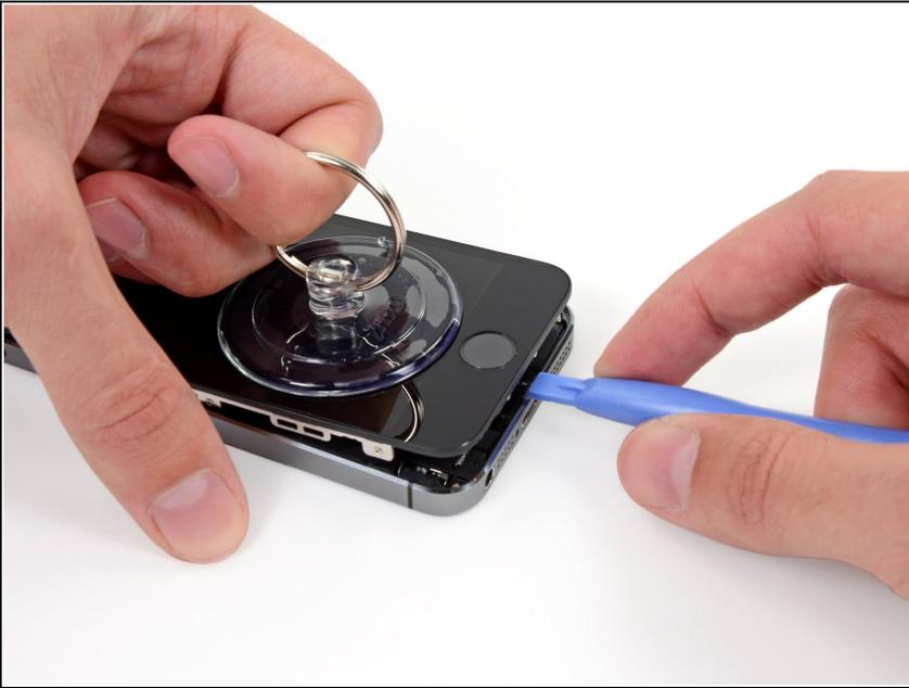
**⚠** Il pannello frontale è attaccato con delle clip, e ci sono diversi cavi a nastro che lo connettono al resto del telefono. Qui l'obiettivo è quello di staccare le clip e **aprire il telefono quanto basta per staccare i cavi**. Procedi lentamente e con cautela per evitare danni.
